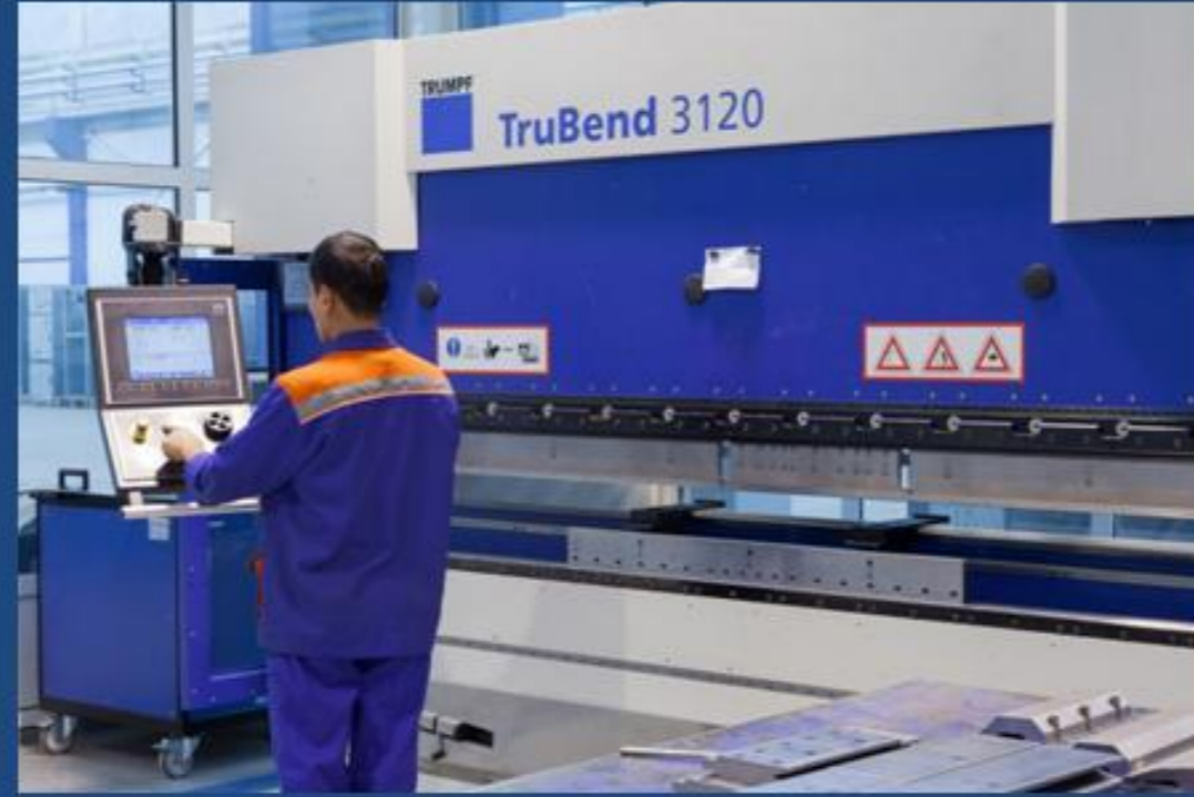
Листогибочный пресс с ЧПУ типа Trubend 3120 и координатно-пробивной центр для обработки листа с ЧПУ типа TruPunch 1000 производства компании «TRUMPF» Германия
