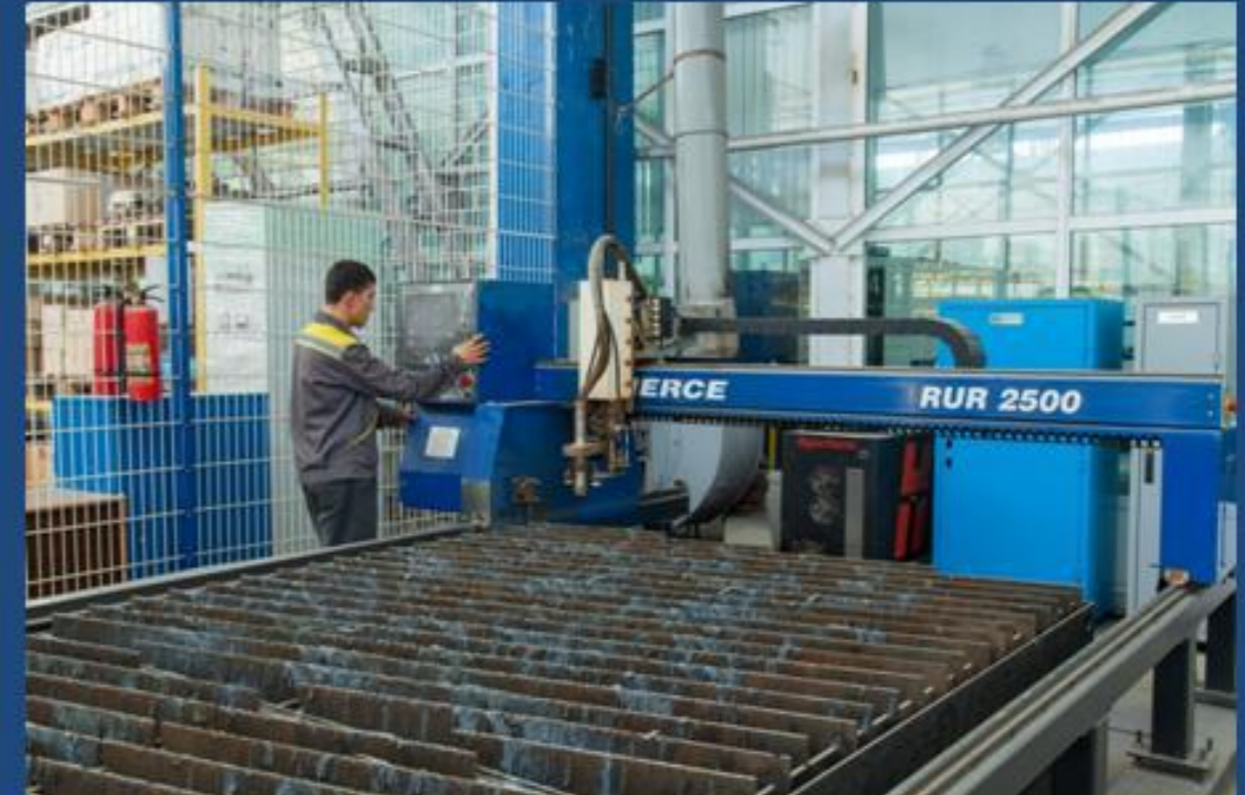
Режущие газовые и плазменные машины с ЧПУ «RUR 2500GP» в комплекте с источником плазмы «Hypertherm HPR-130» США
