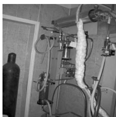
Рис.2. Установка для обработки биосырья диоксидом углерода в состоянии сверхкритической жидкости
