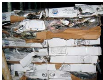
Нарушение упаковки при транспортировке
